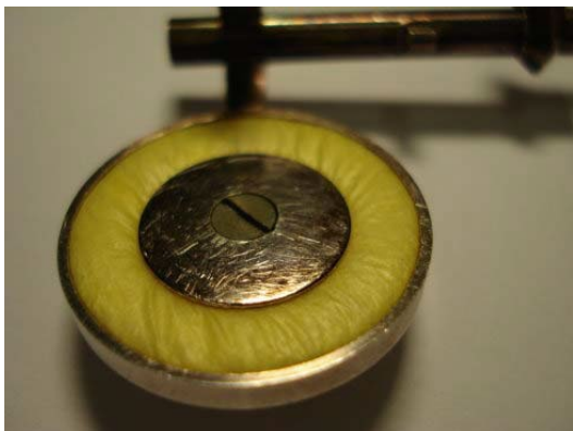
Рисунок 7.34: Морщины на коже подушечки
