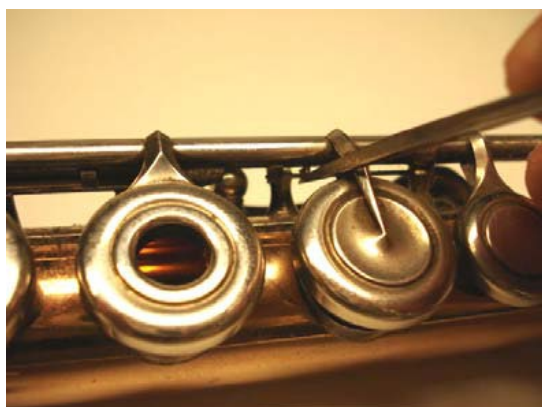
Рисунок 4.58: Освобождение пружины клапана Си-бемоль
