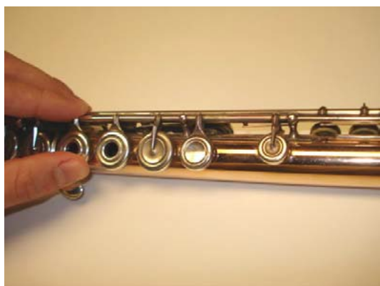
Рисунок 4.68: Вытягивание левосторонней оси
