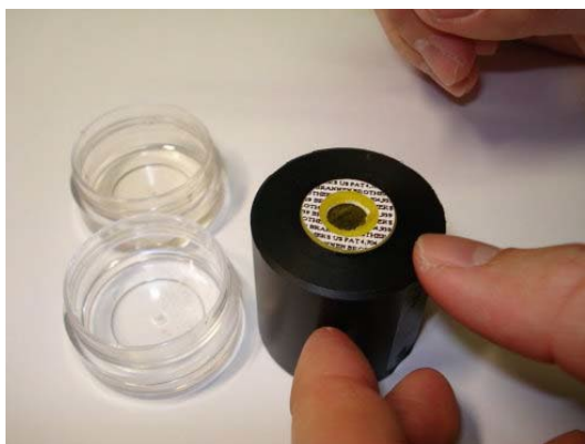
Рисунок 7.85: Завершение процесса замены кожи
