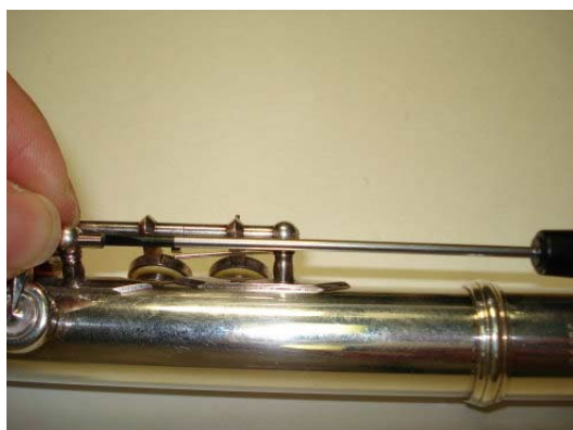
Рисунок 6.47: Установка и затягивание винта
