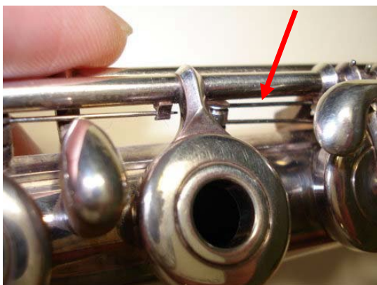
Рисунок 4.24: Опора пружины клапана Фа
