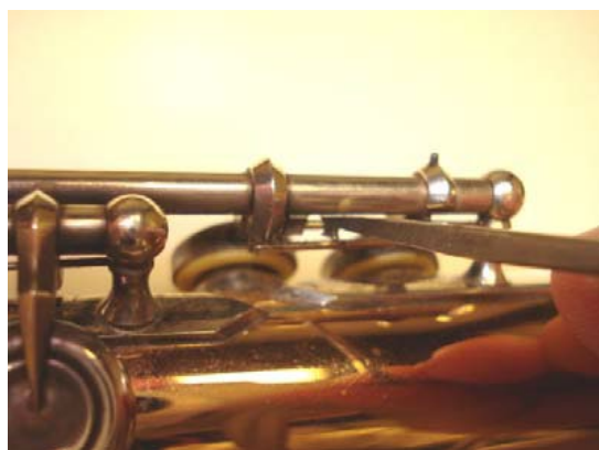
Рисунок 4.64: Отсоединение пружины верхнего трельного клапана
