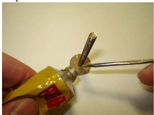
Рисунок 4.113: Нанесение контактного клея на нижний металлический диск
