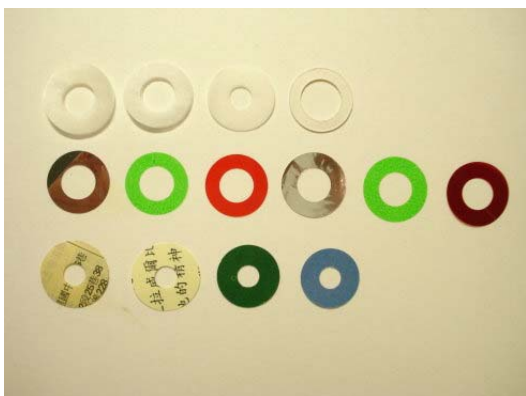
Рисунок 3.20: Прокладки из бумаги и пластика
