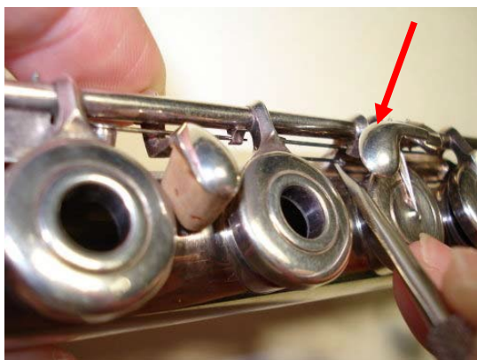
Рисунок 4.23: Отсоединение пружины клапана Фа-диез
