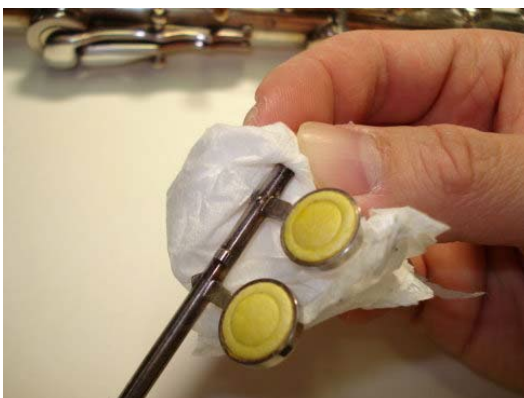
Рисунок 6.19: Очистка обоих концов рычага трельного клапана
