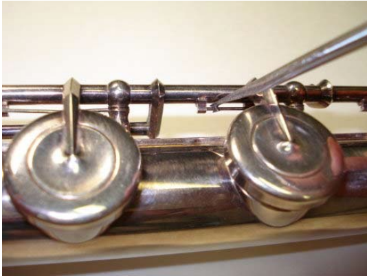
Рисунок 4.6: Отсоединение пружины клапана До
