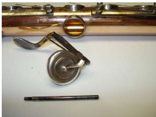
Рисунок 4.90: Клапан Соль-диез и ось
