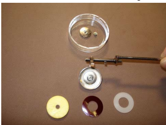
Рисунок 7.25: Тонкая сжатая войлочная прокладка, пластиковая прокладка и пластиковый стабилизатор Delrin
