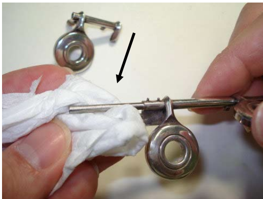
Рисунок 6.25: Очистка рычага клапана Ре
