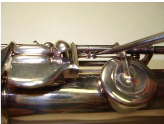
Рисунок 4.5: Отсоединение пружины клапана До-Диез
