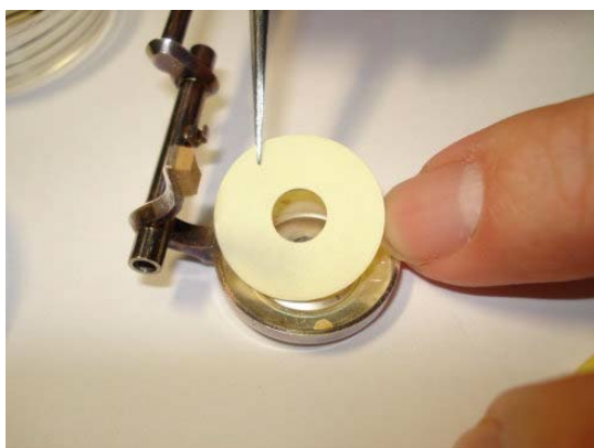
Рисунок 7.12: Установка толстой картонной прокладки в чашку подушечки
