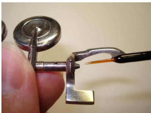
Рисунок 6.36: Удаление старого масла
