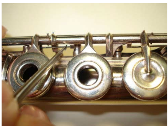
Рисунок 4.20: Отсоединение пружины клапана Си-бемоль
