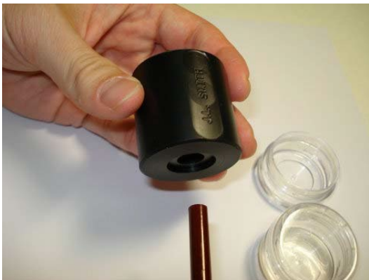
Рисунок 7.71: Выдавливание подушечки наружу
