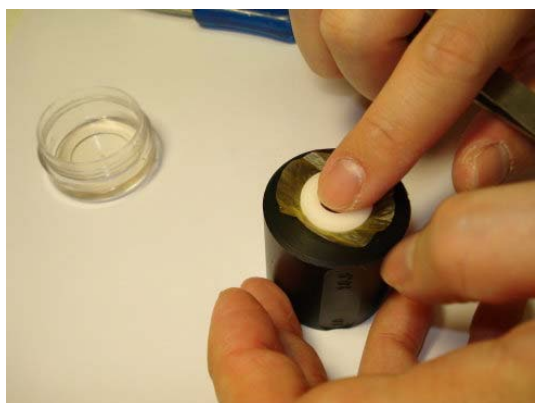
Рисунок 7.62: Вдавите прокладку и синтетический войлок в паз матрицы
