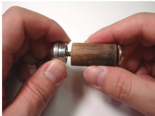
Рисунок 4.106: Отделение пробки от нижнего металлического диска
