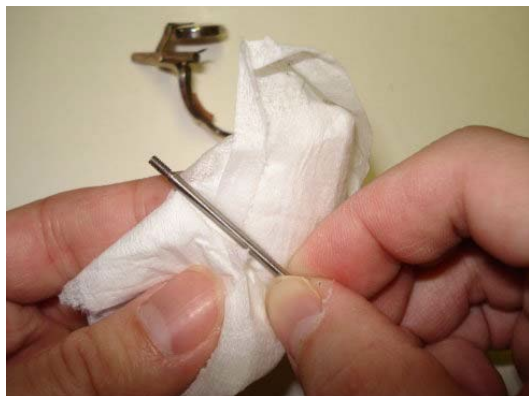
Рисунок 6.2: Очистка оси мягкой тканью или салфеткой без ворса
