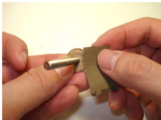
Рисунок 4.110: Шлифовка лака с пробки
