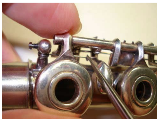
Рисунок 6.34: Подсоединение пружины клапана Ре
