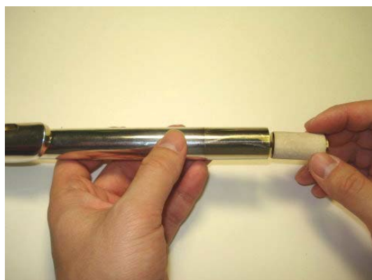
Рисунок 4.117: Вставка новой пробки
