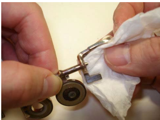
Рисунок 6.36: Удаление старого масла
