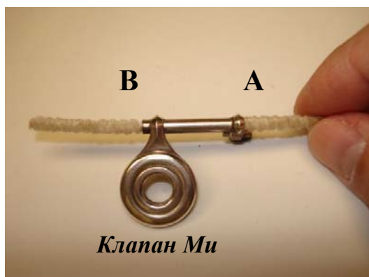
Рисунок 6.56: Введение и извлечение канатика в стержень клапана Ми
