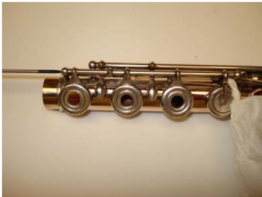
Рисунок 6.73: Затягивание длинной оси
