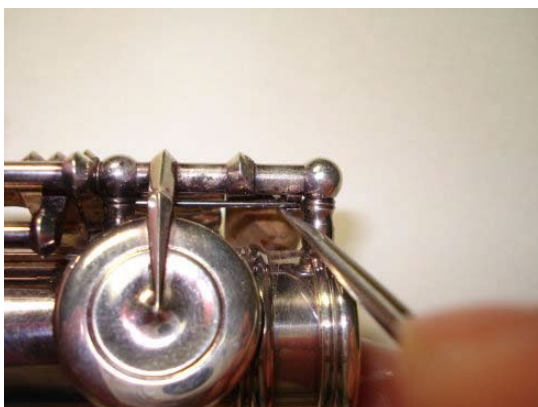
Рисунок 4.3: Отсоединение клапана Ре-диез или Ми-Бемоль
