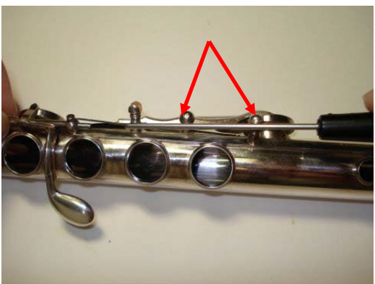
Рисунок 4.45: Отвинчивание клапана Соль-диез
