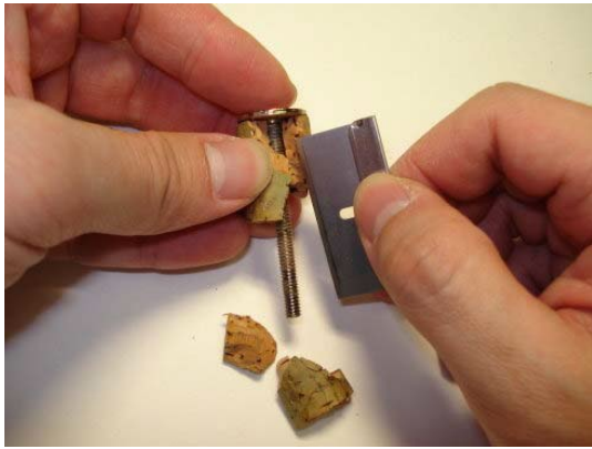
Рисунок 4.108: Разрезание пробки по вертикали
