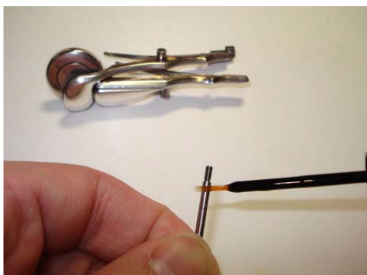
Рисунок 6.14: Нанесение клапанного масла на наконечник оси
