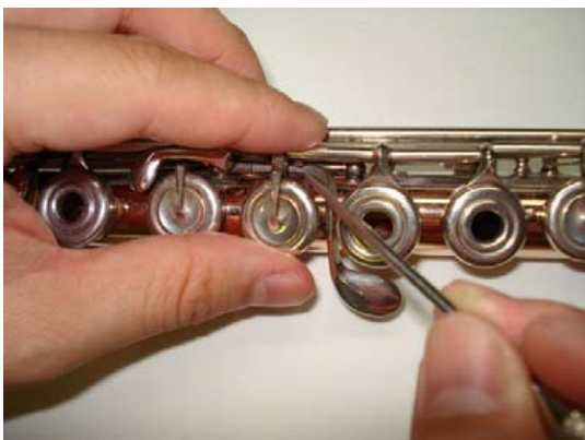
Рисунок 6.80: Сборка тыльных клапанов Соль, Ля, Си-бемоль и До
