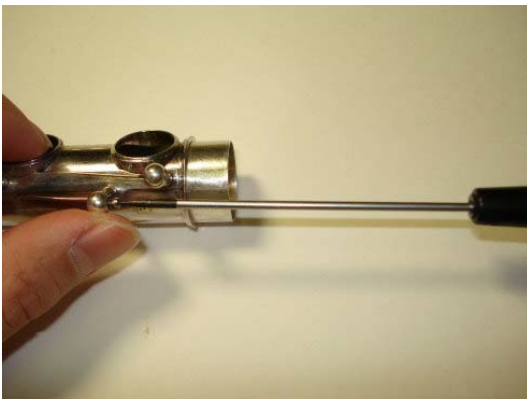
Рисунок 4.43: Поворотный винт правого трельного клапана
