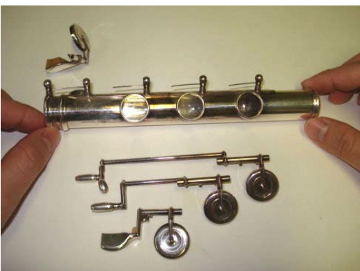
Рисунок 4.15: Извлечение клапана До
