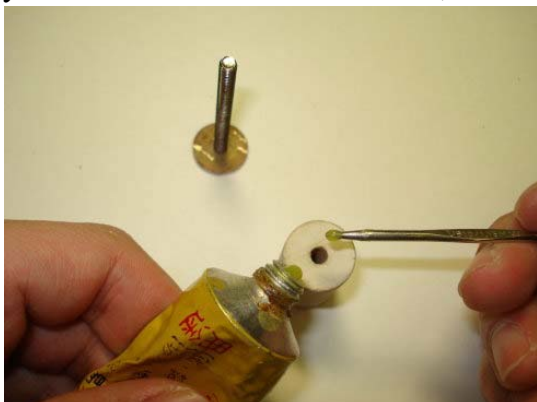
Рисунок 4.112: Нанесение контактного клея на одну сторону пробки
