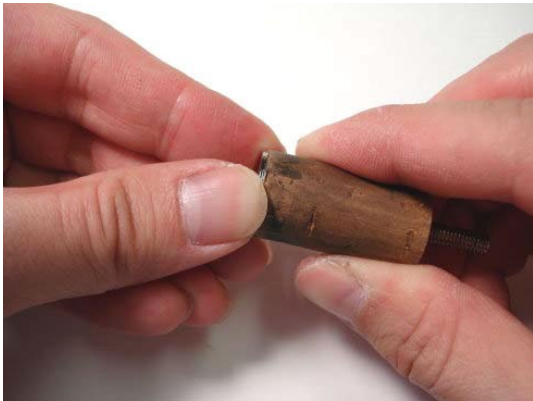
Рисунок 4.104: Скручивание пробки с центрального винта
