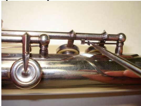
Рисунок 4.27: Отсоединение пружины клапана верхней трели
