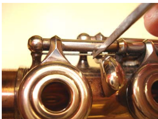
Рисунок 4.62: Отсоединение пружины клапана Ре
