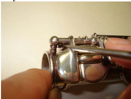
Рисунок 4.4: Отталкивание пружины от пружинного захвата
