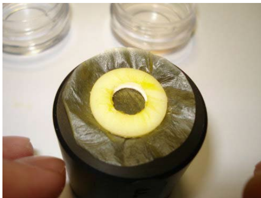
Рисунок 7.77: Размещение расправленной кожи и подушечки на матрице
