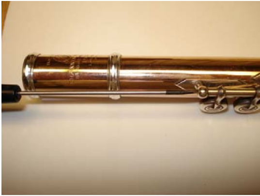
Рисунок 4.79: Отвинчивание левостороннего шарнирного винта
