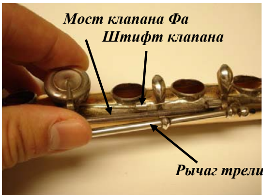
Рисунок 4.81: Снятие моста клапана Фа
