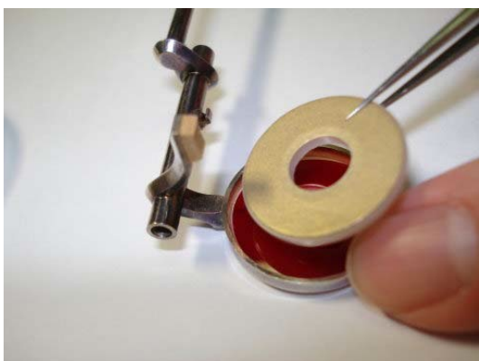
Рисунок 7.43: Установка новой золотой подушечки
