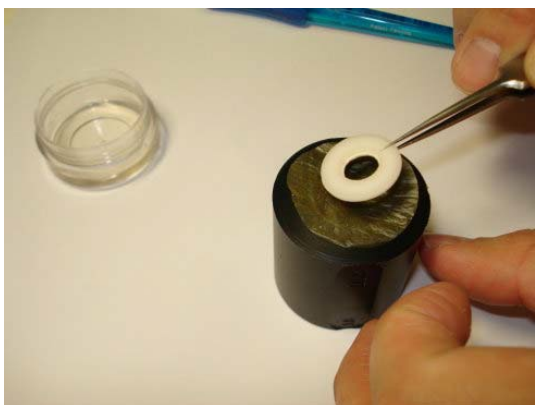
Рисунок 7.61: Переворачивание прокладки для подушечки вверх дном
