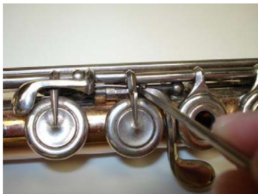
Рисунок 4.69: Отсоединение пружины клапана Соль.
