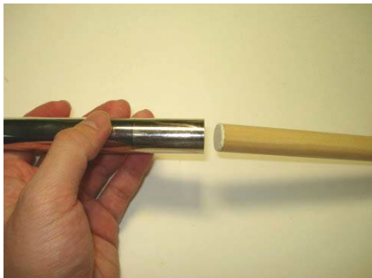
Рисунок 4.118: Введение шомпола для установки пробки
