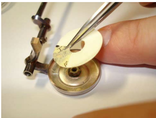
Рисунок 7.8: Удаление старых регулировочных прокладок
