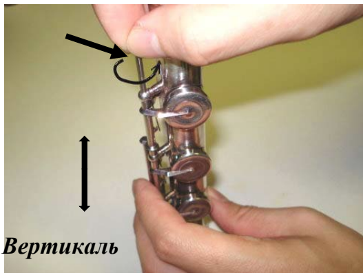
Рисунок 4.9: Вертикальное положение и выкручивание оси
