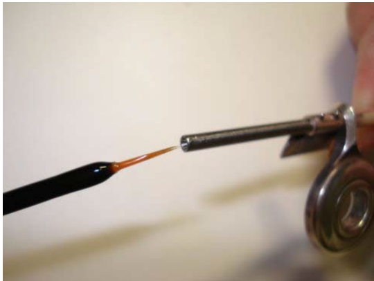
Рисунок 6.29: Нанесение клапанного масла в отверстие стержня
