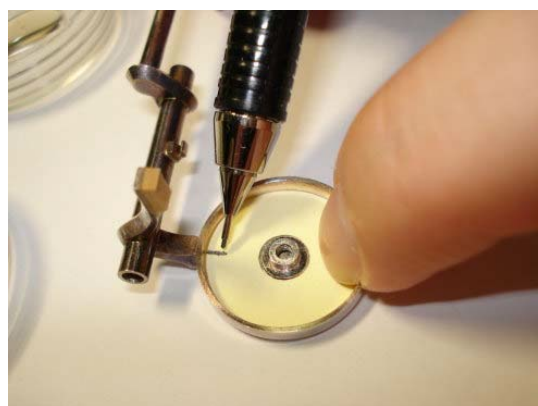
Рисунок 7.13: Обеспечение того, чтобы прокладка оставалась на месте
