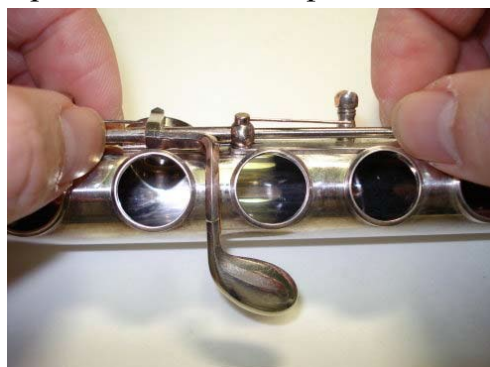
Рисунок: 6.10: Вставка оси
