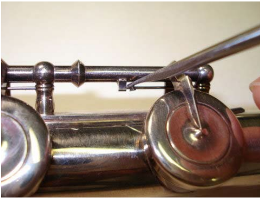
Рисунок 4.7: Отсоединение пружины нижнего клапана Си
