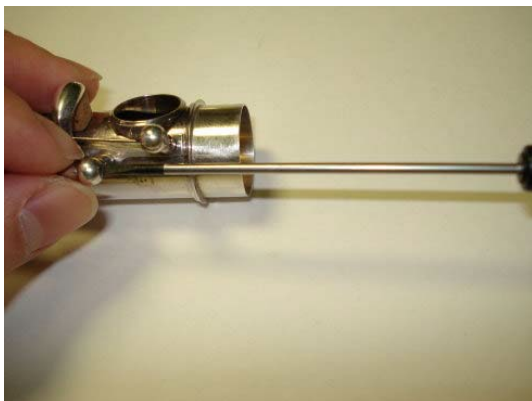
Рисунок 4.41: Отвинчивание правого поворотного винта
