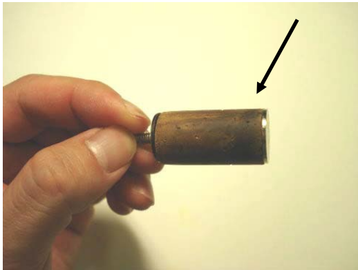
Рисунок 4.101: Вода попадает на дно пробки
