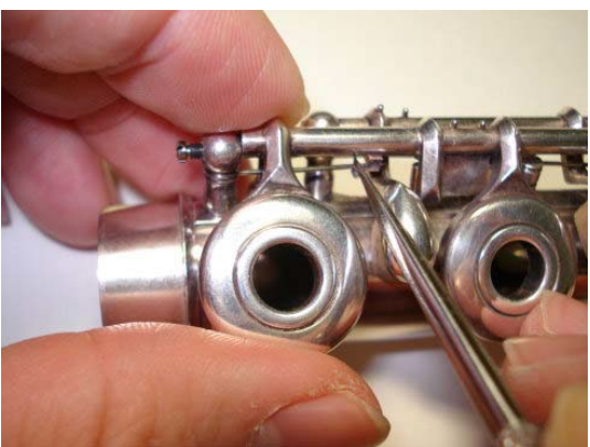
Рисунок 4.36: Отсоединение пружины клапана Ре
