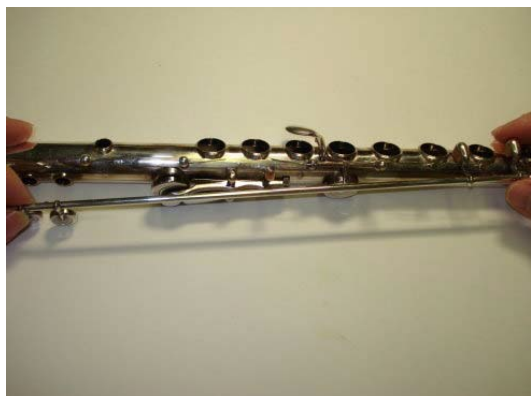
Рисунок 6.22: Сборка тыльной части механизма трельного клапана
