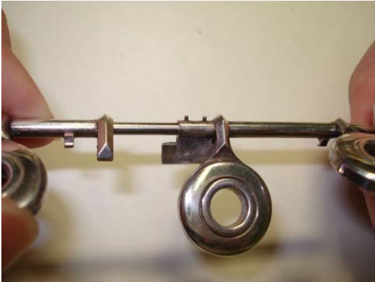
Рисунок 6.30: Установка клапана Рв обратно
