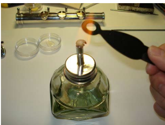
Рисунок 7.35: Нагрев гладильной лапки
