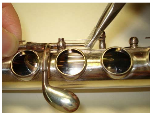
Рисунок 4.47: Вытягивание оси клапана Соль-диез
