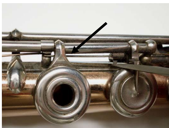
Рисунок 4.59: Освобождение пружины клапана Ля
