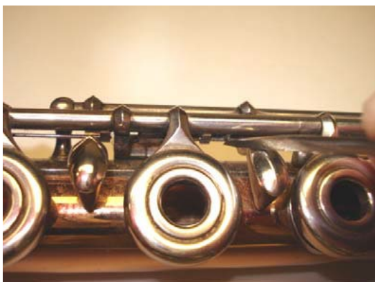
Рисунок 4.61: Отсоединение пружины клапана Ми
