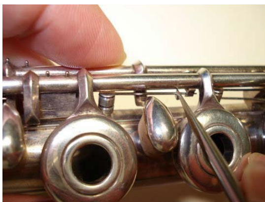
Рисунок 4.24: Опора пружины клапана Фа
