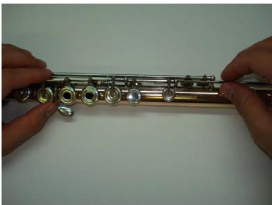
Рисунок 6.81: Установка и затягивание левосторонней длинной оси
