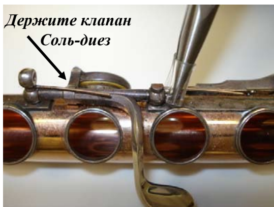
Рисунок 4.87: Вытягивание оси клапана Соль-диез
