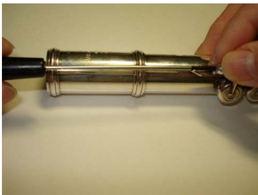
Рисунок 4.40: Отвинчивание левого поворотного винта
