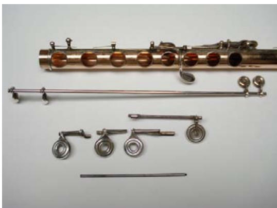
Рисунок 4.84: Полный правосторонний механизм
