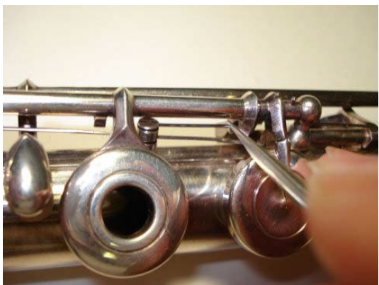
Рисунок 4.37: Отсоединение пружины верхнего клапана Фа
