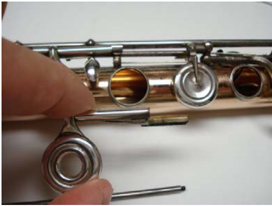
Рисунок 4.75: Снятие клапана Фа
