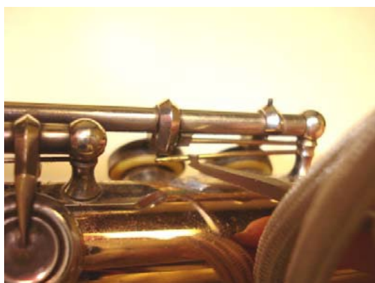
Рисунок 4.63: Отсоединение пружин трельного клапана
