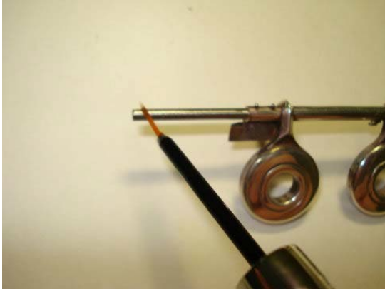
Рисунок 6.28: Нанесение клапанного масла на кончик стержня
