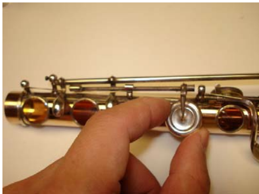
Рисунок 6.65: Установка клапана Фа-диез
