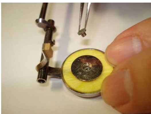
Рисунок 7.32: Установка винта на место
