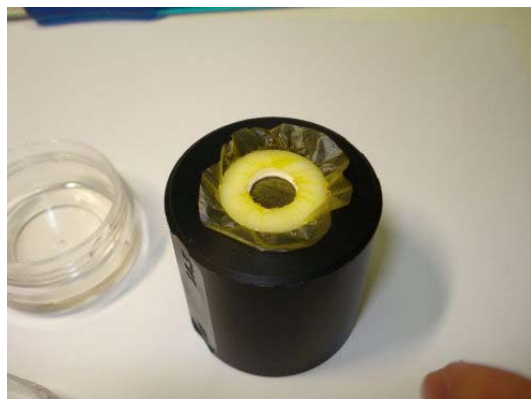
Рисунок 7.79: Вдавите подушечку в паз матрицы
