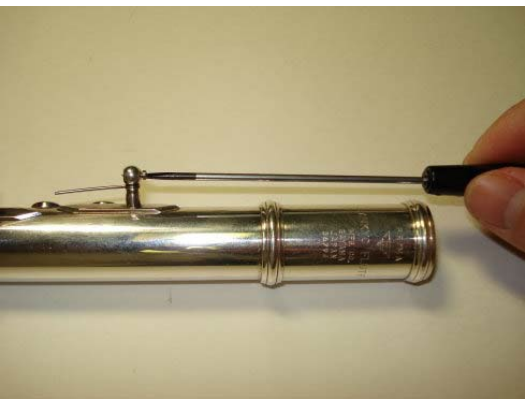
Рисунок 4.44: Откручивание поворотного винта правого трельного клапана
