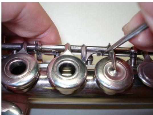
Рисунок 4.20: Отсоединение пружины клапана Си-бемоль
