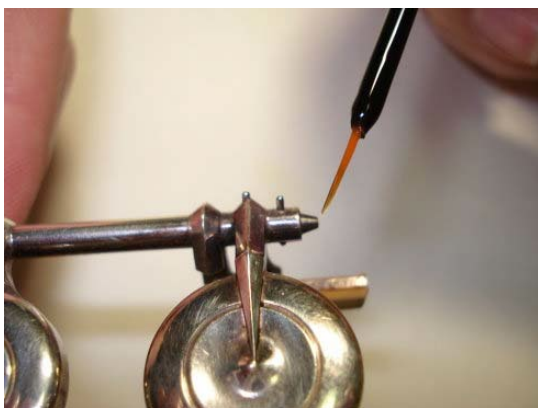
Рисунок 6.32: Очистка и смазка оси
